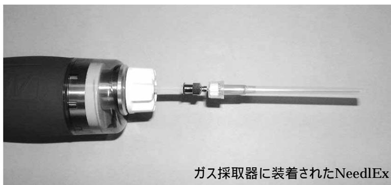
両端のテフロン栓をはずし、付属品のテフロンチューブを使ってガス採取器に接続します。試料採取は安全カバーを付けた状態で行ってください。
